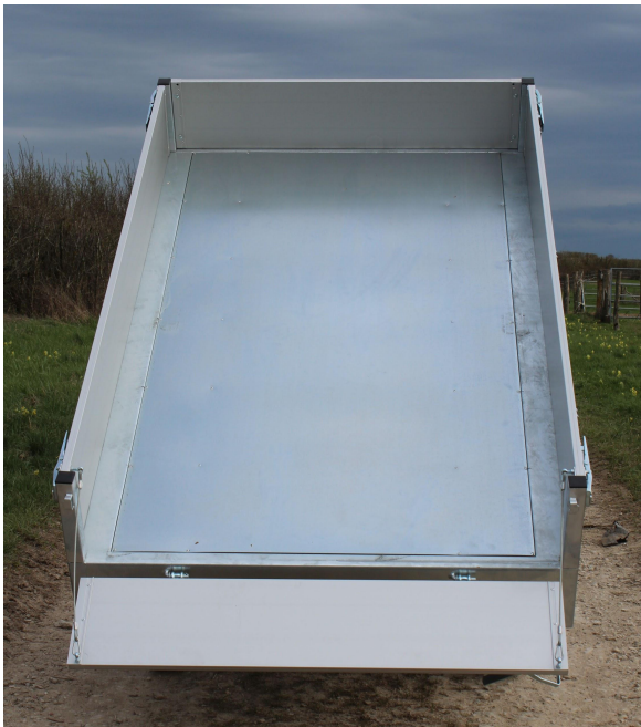
Plancher Multiplis recouvert d'une feuille de Tôle : de série sur modèle LUX, Feuille de Tôle en option sur modèle ECO
