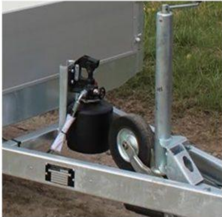
Modèle LUX : commande pompe électrique
